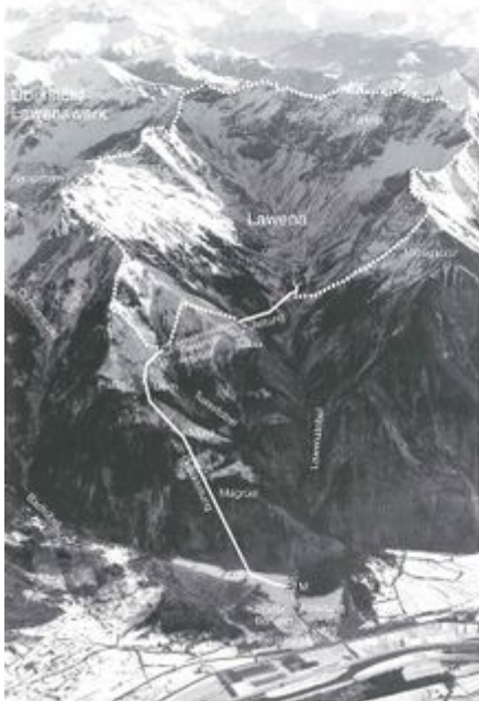
Das Lawenawerk nach dem Ausbau von 1985–1987: Einzugsgebiet im Lawental, Fassung, Wasserschloß (1380 m.ü.M.), Druckleitung und Maschinenhaus (500 m.ü.M.) (© Liechtensteinische Kraftwerke, Schaan).
